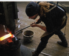
Im Inneren der Schmiedekohle (links oben) muss die Temperatur gleichmäßig sein. In einer Klinge stecken bis zu 600 Lagen Stahl. Erstmal kommt sie unter den Hammer.
