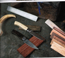
Von der Skizze bis zum fertigen Messer: Der Schmiedehörling wird bei zirka 900 Grad bearbeitet. Die Griffe werden zum Beispiel aus einem Warzenschweinohr, aus Karmalknochen oder aus Zircote-Holz gefertigt.
